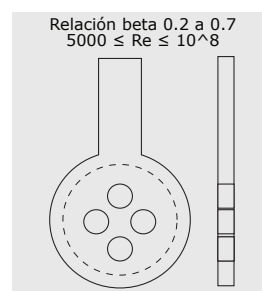
Fig 5. Acondicionadora de flujo.
