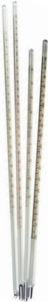
En la actualidad los termómetros de líquido en vidrio se fabrican para aplicaciones específicas de medición. A pesar de la gran variedad de instrumentos para la medición de temperatura, prohibición del mercurio, los termómetros de líquido en vidrio son frecuentemente utilizados por su facilidad de uso, portabilidad, costo, estabilidad, amplio intervalo de trabajo y/o por recomendaciones en normas.
