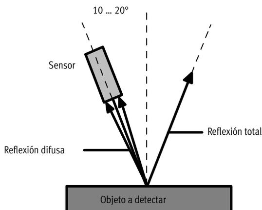
En los sensores de reflexión directa con diferenciación de la intensidad, los sensores de reflexión directa con supresión de luz de fondo y los sensores de color y de distancia, la detección se basa en la reflexión difusa. Por ello, estos sensores necesitan una reflexión difusa lo más intensa posible. La reflexión total dificulta la detección y, por lo tanto, no es apropiada.
