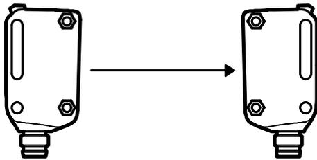
En los sensores de barrera, el emisor y el receptor se encuentran en cuerpos diferentes, por lo que deben instalarse uno enfrente del otro. Se detecta cualquier objeto que interrumpe el haz de luz entre emisor y receptor. Este método es muy fiable, especialmente en condiciones ambientales difíciles. Su desventaja consiste en que es necesario tender y configurar cables para dos componentes separados (el emisor y el receptor).
