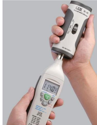
SC-05 calibrador de sonómetro. Este dispositivo está diseñado para calibrar sonómetros de 1/2" y 1/4" de micrófono. Este calibrador cumple con IEC 942 Clase 2 estándar. Su tamaño compacto hace que del dispositivo fácil de transportar y manejar. Idealmente, el medidor de sonido debe ser calibrado una vez al año.
