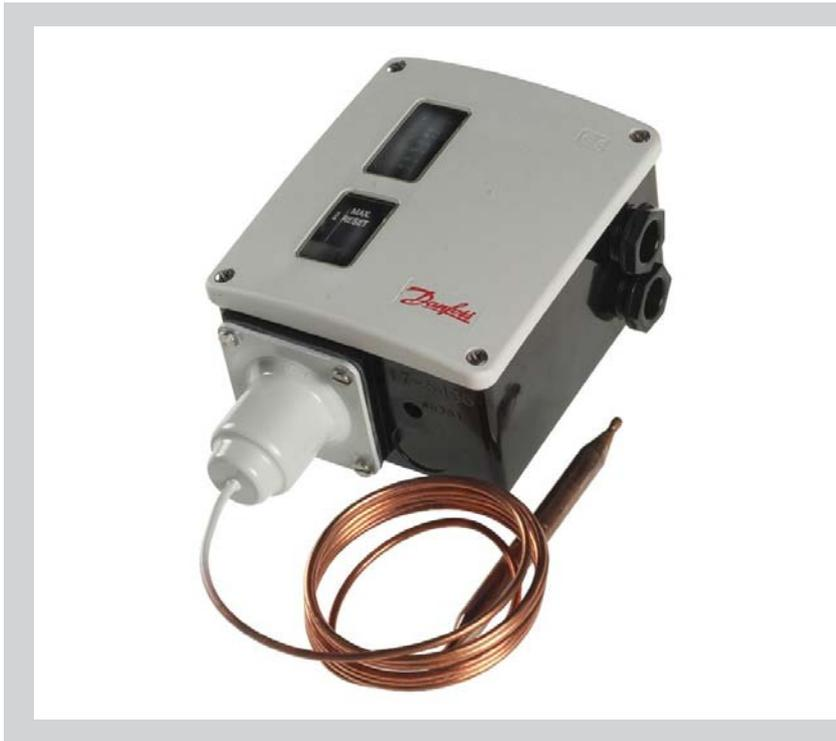
Los termostatos RT incorporan un conmutador unipolar controlado por temperatura en el que la posición de contacto depende de la temperatura del sensor y del valor de escala definido.
