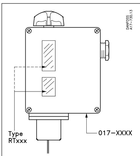
La designación de tipo de la unidad se indica en la escala de ajuste. El número de código está estampado en el fondo de la caja del termostato.
