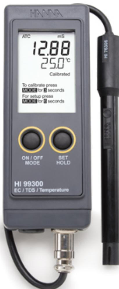
El HI 99300 y el HI99301 son medidores de temperatura. El HI99300 mide rangos bajos de conductividad en ms-cm y TDS en ppt mientras que el HI99301 mide altos rangos de conductividad en ms-cm y TDS en ppt. Ambos instrumentos son almacenados en un estuche valorado para condiciones IP67.
