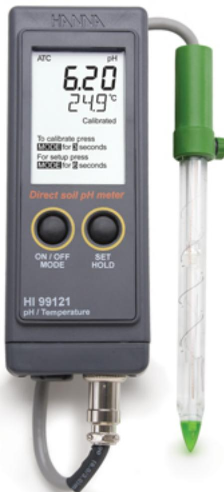
Con HI 99121 y HI 1292D como sonda de temperatura y pH pre-amplificado directo a suelo, los usuarios pueden evaluar tanto el pH del suelo directamente o después de la preparación de una muestra diluida.
