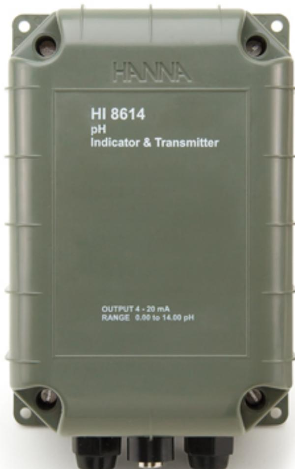
El transmisor HI 8614N es resistente al agua y está diseñado para ser utilizado con un estándar de alta impedancia de la sonda de pH con Conector BNC. La señal es entonces procesada por un especie de amplificador de alta impedancia, el cual transmite una salida de corriente directamente proporcional a la señal de entrada, pero independiente de los cambios en carga o la capacitancia del cable.
