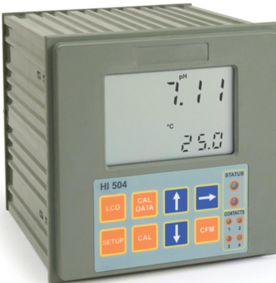
EL HI 504 es un controlador de pH/ORP de tipo PID, PI, proporcional u on/off con uno o dos puntos de ajuste. Las opciones de configuración de medición y control de pH y ORP se guardan por separado y permite a los usuarios cambiar entre pH y ORP sin perder los ajustes. El canal de pH puede ser calibrado en dos puntos de calibración. El equipo tiene un procedimiento de autodiagnóstico completo. Sensor Check? también está disponible para las sondas de pH y ORP.
