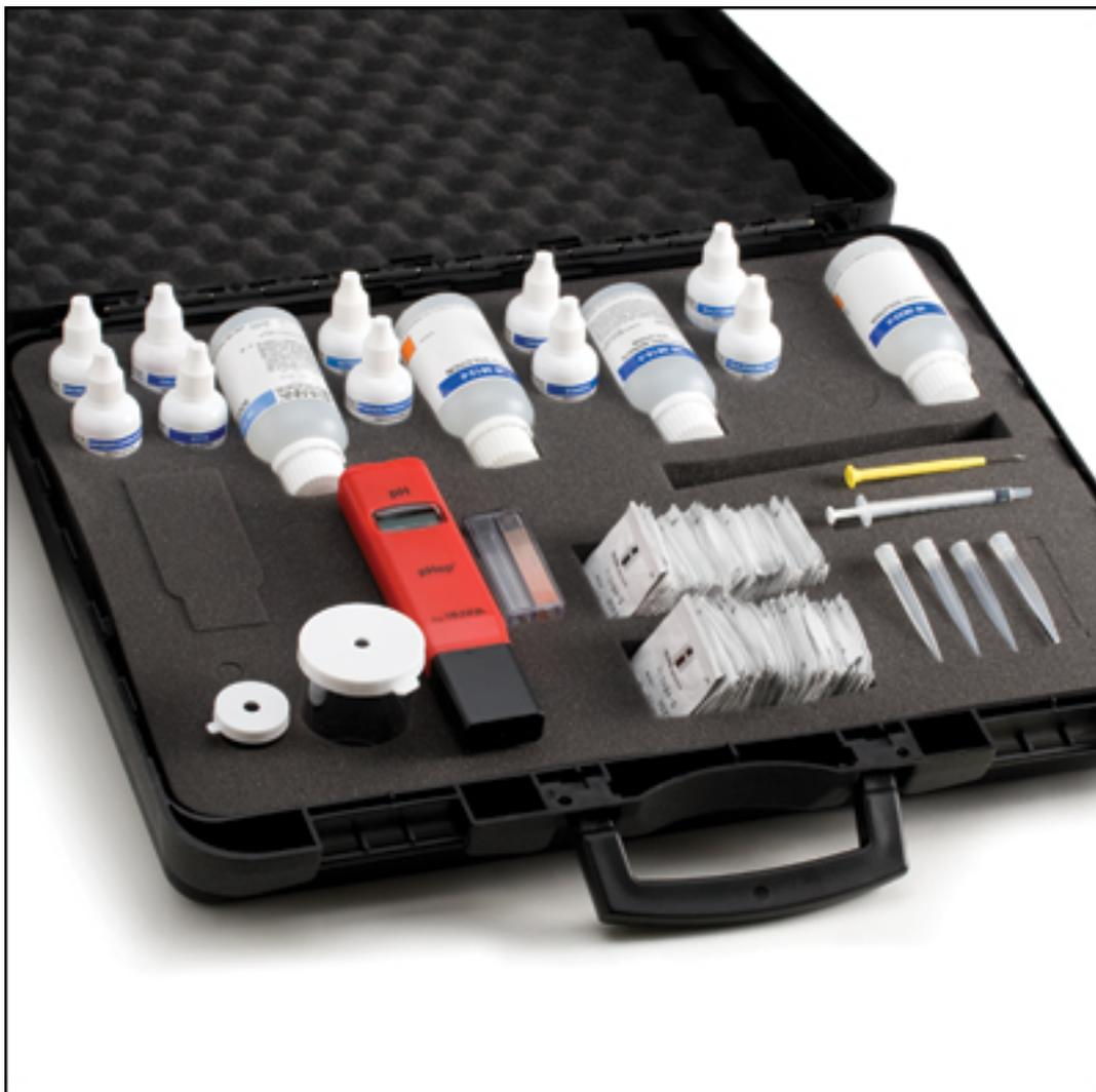
Monitoree los más importantes parámetros químicos en el agua: alcalinidad, cloro, dureza, hierro, pH y sulfito con este kit de pruebas combinadas.
