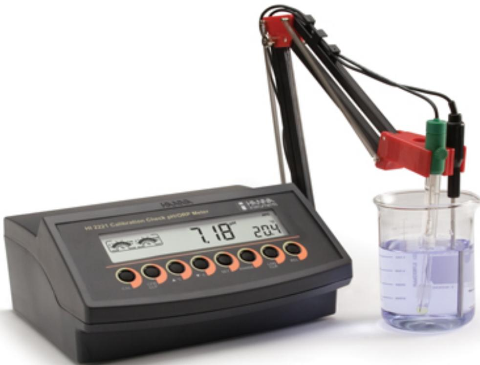
Los medidores de mesa HI 2221 que poseen nuestra exclusiva Calibración Check? hace diagnósticos tanto para electrodos de pH y soluciones buffers durante la calibración. Estos instrumentos comparan el electrodo de pH de una calibración a la siguiente. En caso de que existen grandes variaciones en la condición del electrodo, estos medidores alertan al usuario que el electrodo necesita ser apropiadamente limpiado antes de la calibración y de la medición.
