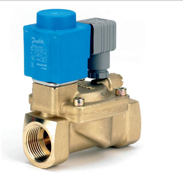
La EV224B es una válvula solenoide de 2/2 vías servoaccionada de forma indirecta, con una presión de trabajo máxima de 40 bar, apta para medios a temperaturas de hasta 60 °C y disponible en versiones NC y NO.
