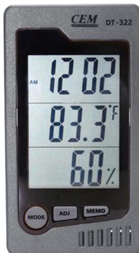
Termohigrómetro con pantalla LCD grande y clara, muestra la hora, la temperatura y la humedad, pueden mostrar los valores más bajos y más altos medidos.
