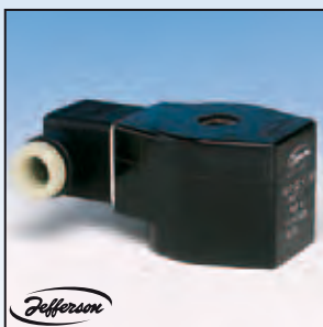
BOBINAS CAPSULADAS DIN 43650 Conjunto bobina y carcasa a prueba de intemperie y humedad, conexión: Plug-in con prensa cable o conduit de 1/2 NPT. Protección: IP65. Opcional: Indicador luminoso.
