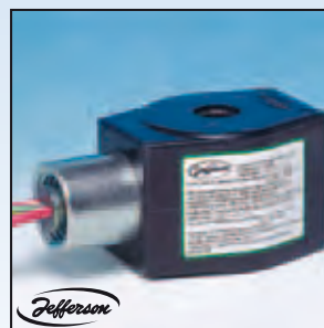
BOBINA A PRUEBA DE EXPLOSIÓN Conjunto bobina y carcasa capsuladas; responde a las normas IEC79-18 para zonas clase I, div.1, grupos A,B,C y D y clase II, div. 1, grupo E. BOBINA NEMA 4 X A prueba de intemperie, agua y corrosión salina.
