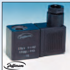
MINI BOBINA CAPSULADA DIN 43650 Conjunto de bobina y carcasa compacto a prueba de intemperie y humedad. Conexión eléctrica: Plug-in con prensa cable. Protección: IP65.
