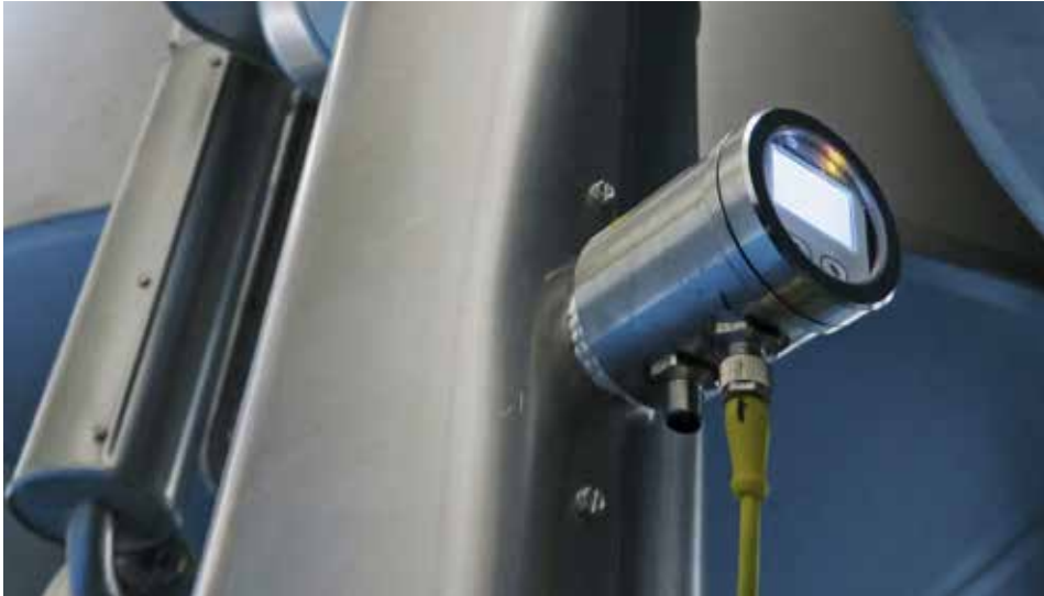
Sensor de conductividad inductivo diseño modular
