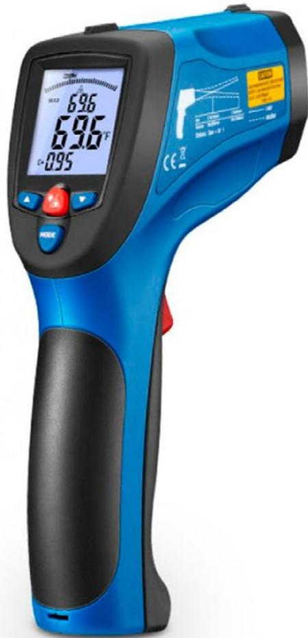
Equipo capaz de proporcionar lecturas fáciles, rápidas y precisas con sus punteros láser duales, en la mayoría de las superficies donde se requiera mediciones de temperatura. Sus dos puntos de láser convergen en un único punto cuando la pistola está a la distancia óptima del objeto a medir.
